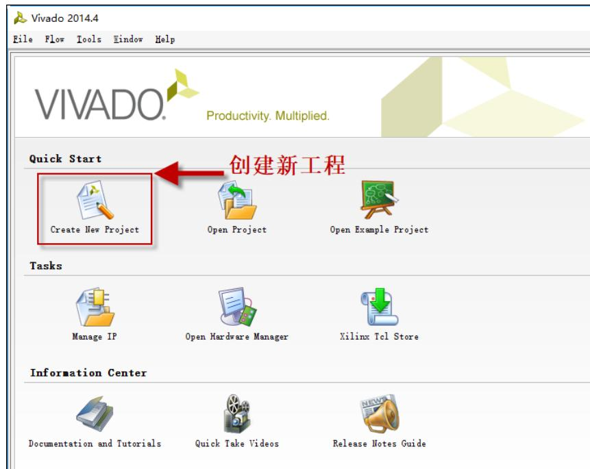
图 3-1 Vivado 下创建新工程
