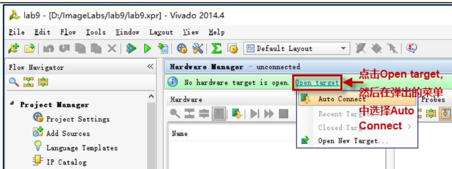
图 3-38 在 Hardware Manager 下 Open target
